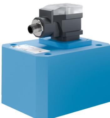
带 IO-Link 技术设备的 VC 流量计基于带有一个或两个传感器的标准 VC。与只向分析电子装置提供方波信号的标准版本或编码器版本不同, IO-Link 设备还能在内部计算具体测量值。因此, 此类流量计可用于传统 PLC 以及 IO-Link 基础结构。详细信息请参阅第 16 页。
