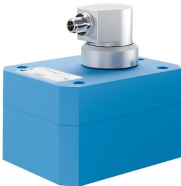
与标准传感器相比, 编码器能够产生更多的脉冲。这使测量值分辨率倍增。带有编码器的 VC 流量计每转最多可产生 2500 个脉冲, 还可检测流动方向。编码器 (与标准版本一样) 向分析电子装置发送方波信号。
